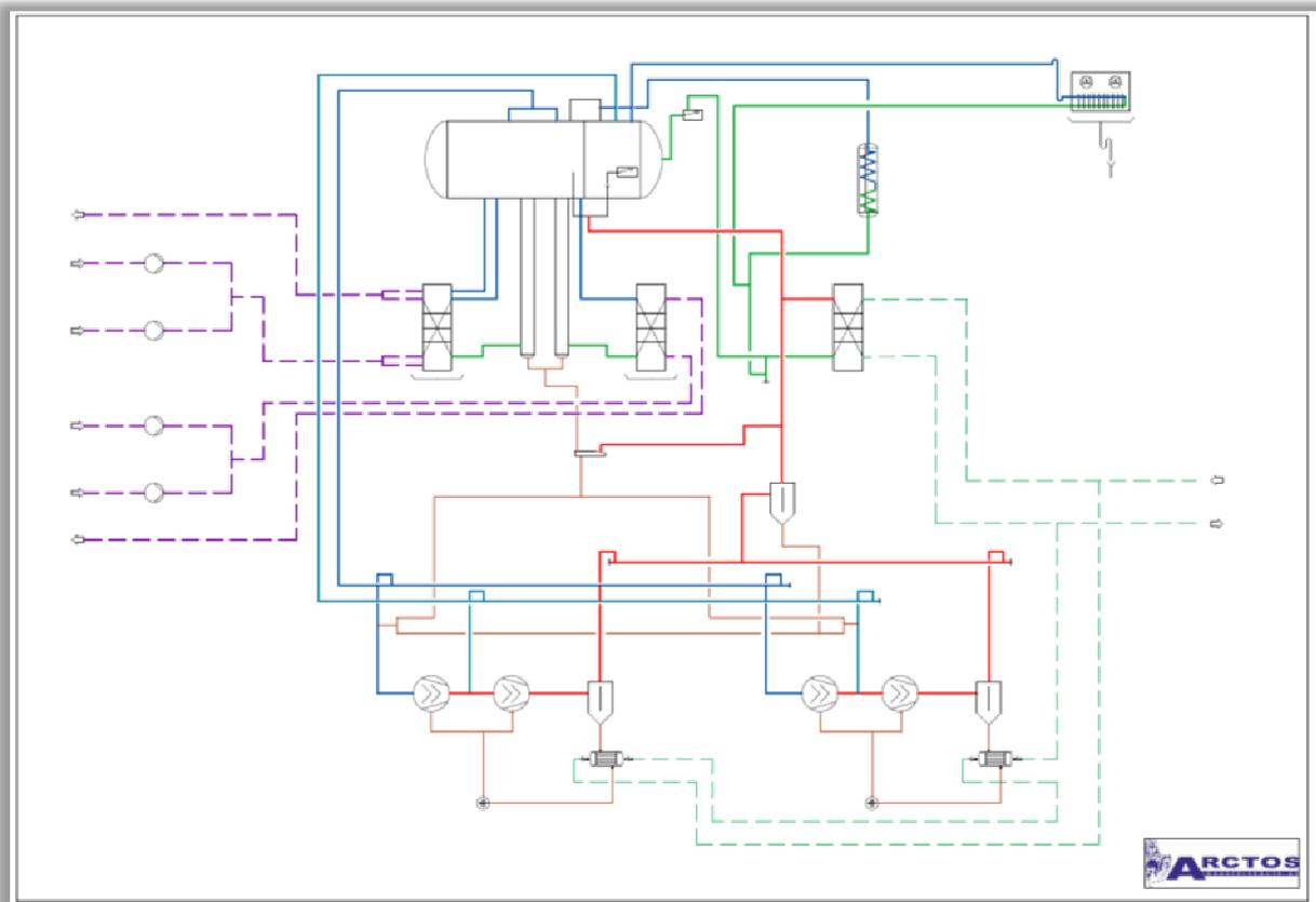
Um die tiefe Verdampfungstemperatur zu realisieren, erfolgt die Ausführung der NH<sub>3</sub>-Schraubenverdichter in 2-stufiger Ausführung. ND- und HD-Stufe sind hierbei in einem Unit integriert und verfügen über eine ECO-Zwischeneinspeisung zur zusätzlichen Energieeffizienz. Bei der Kälteanlage handelt es sich um eine NH<sub>3</sub>-Anlage mit 2 aufgrund der Verfügbarkeit redundanten Kältemittelverdichtern mit getrennten 500V-E-Motoren, die mit FU betrieben werden.
