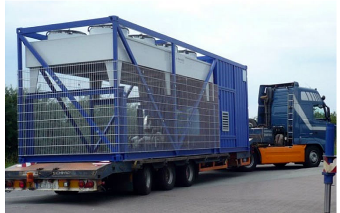
Mobile NH 3 -Kälteanlage
